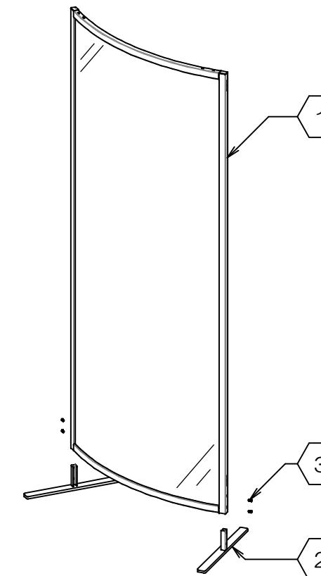
製品仕様 外形寸法：YS-F03=幅95cm×奥行40cm×高180cm 重量：11.5kg
