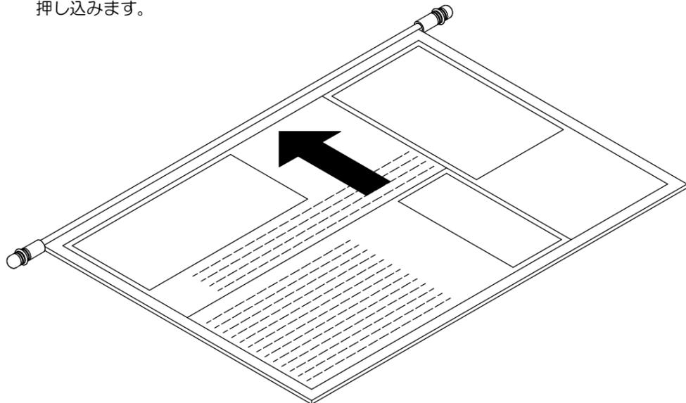
製品仕様 外形寸法：巾650mm×奥行14mm×高14mm 重量：60g
