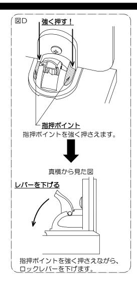
※ 天板に直接設置される場合で、取り付け後すぐに①吸盤脚が外れる際は、天板に 目に見えない線キズ・点キズ・凸凹等があり空気が浸入していることが考えられます。 そのような場合は、作業3个戻り⑤下地フィルムを天板に貼り付けてご使用下さい。
